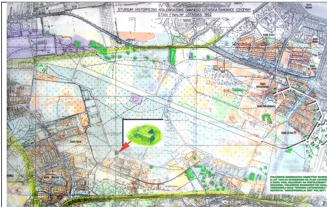
Lotnisko Kraków Rakowice-Czyżyny w stanie po zakończeniu 2 wojny światowej. Po prawej (str. wschodnia lotniska) widoczna strefa rozproszenia. Widoczne także inne elementy lotniska: droga startowa i droga kołowania, łącząca strefy hangarowe. Wskazano formy i lokalizację schronów podziemnych dla personelu. Oprac. K. Wielgus.
